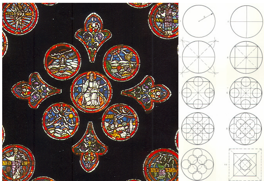
Abb. 8: Das Zentrum der Rose im Hauptglasfenster der Kathedrale in Lausanne und die Konstruktion als Superposition von Kreisen und Quadraten.
